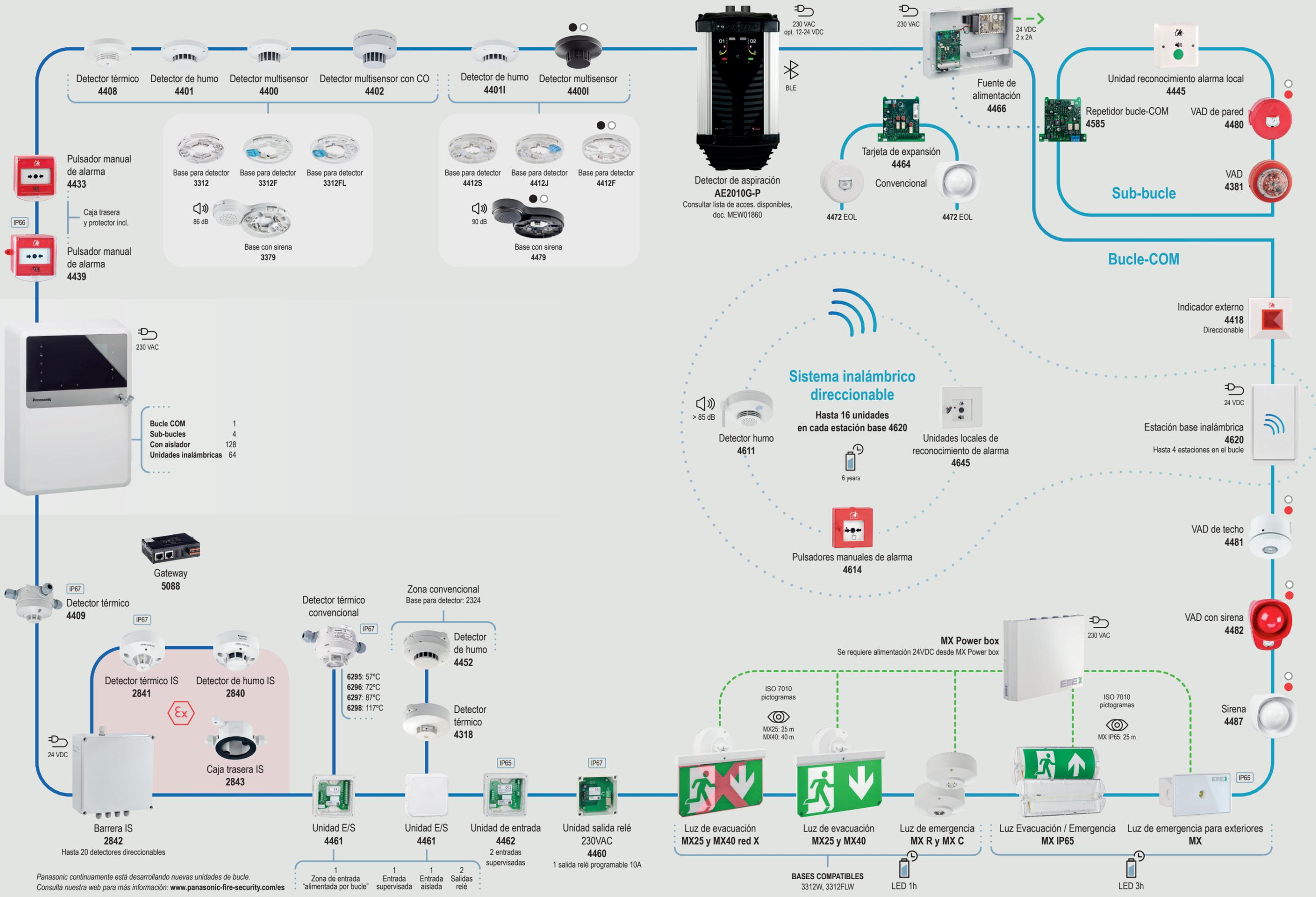
Detector térmico 4408    Detector de humo 4401    Detector multisensor 4400    Detector multisensor con CO 4402
